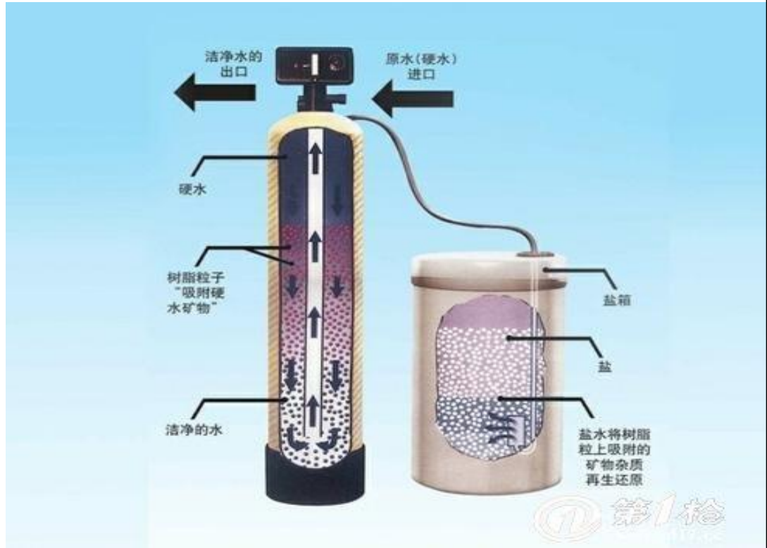
图 4-1 全自动软水器工作原理示意图
