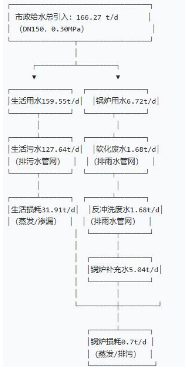
图 2-1 项目水平衡图
