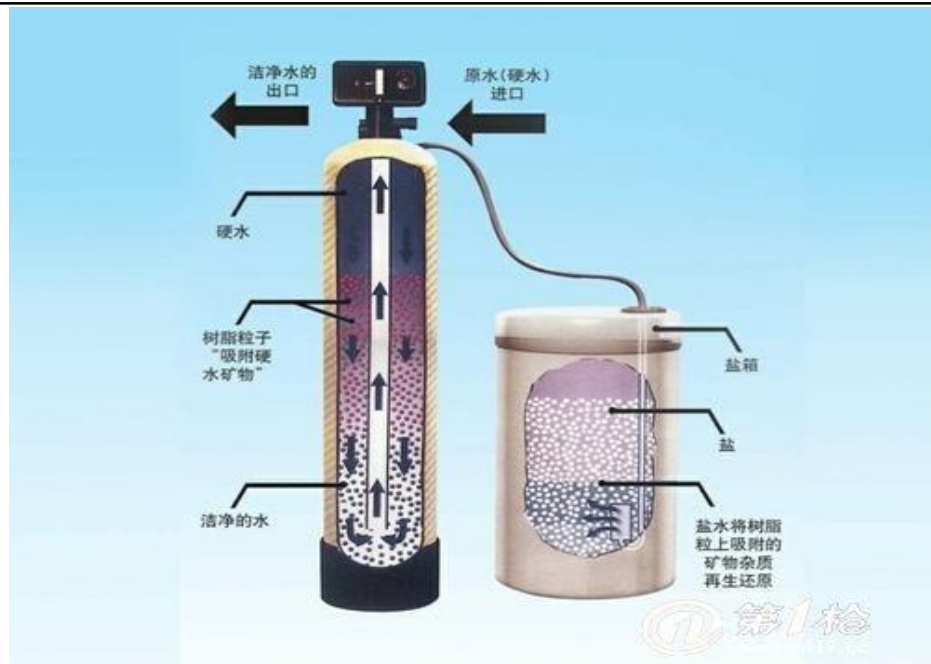
图 2-3 全自动软水器工作原理示意图
