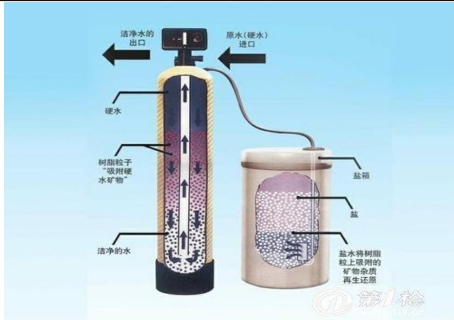
图 2-3 全自动软水器工作原理示意图
